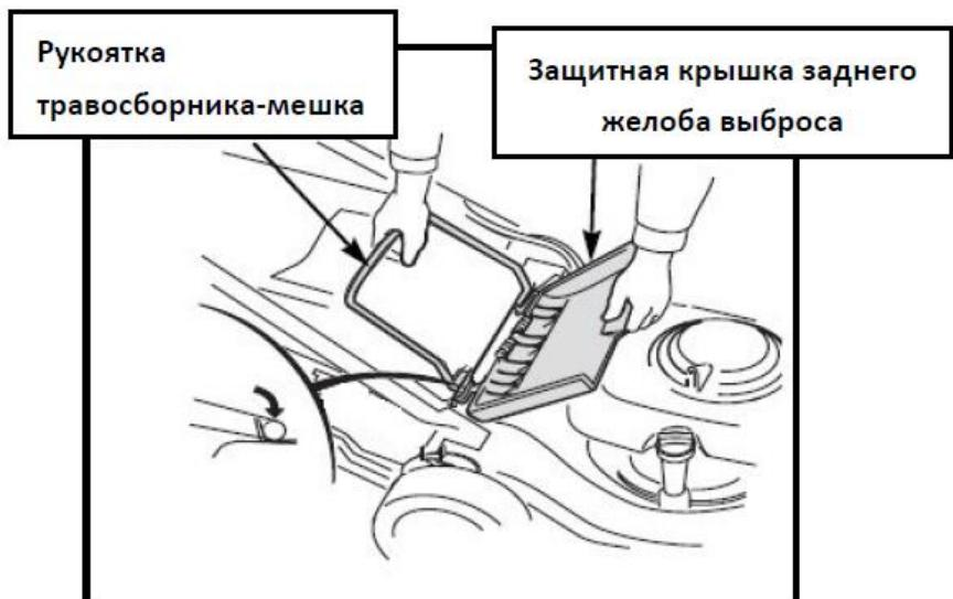
Заглушка для мульчирования позволяет использовать место внутри деки косилки для более эффективного измельчения травы. Чтобы установить/снять заглушку для мульчирования, поднимите защитную крышку заднего выброса, как показано на рисунке. Заглушка для мульчирования подходит только в одном направлении. Уберите заглушку для мульчирования при использовании травосборника-мешка.
